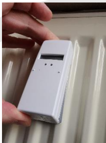
7-14 MONTAGE EHKV AUF WÄRMELEITER
